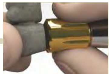
Рассверливание кромки каркаса римером
