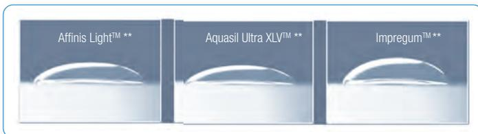
\* Сравнительный тест выполнен компанией Kettenbach путем замеров контактного угла, который определяли с помощью измерительного прибора DAS 100, фирма Kruss, 2006. Оценку выполняли с помощью метода circle-fit (аппроксимация единичной окружностью).
