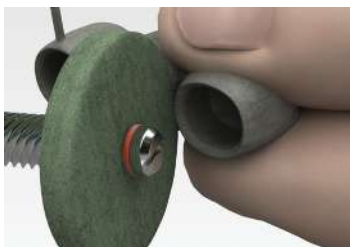
Шлифовка наружного края каркаса полировочным диском
