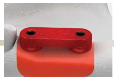
Изготовление позиционирующего шаблона
