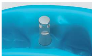
Установка лабораторного аналога в слепок
