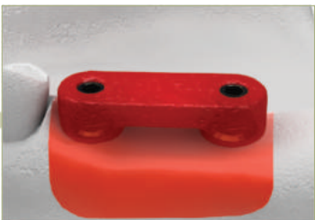
Изготовление позиционирующего шаблона
