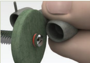
Шлифовка наружного края каркаса полировочным диском
