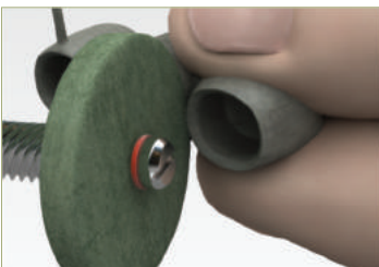
Шлифовка наружного края каркаса полировочным диском
