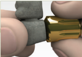
Рассверливание кромки каркаса римером
