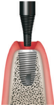
Имплантат с внутренним конусом 11°
